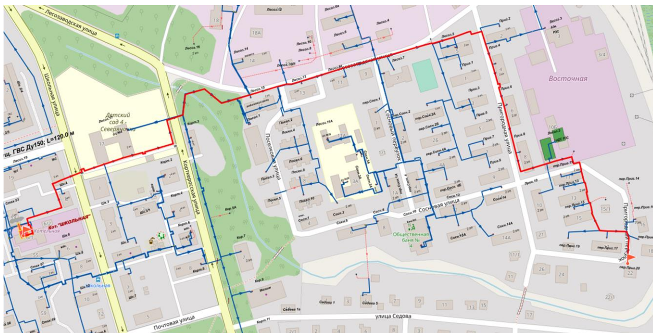
Рисунок 9. Путь движения теплоносителя от котельная «Школьная» до ж/д
